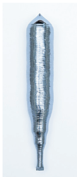
棒状の原料（シリコン）の一部を高周波や集光加熱によって溶融すると、液体状の溶融帯（写真中央の光っている部分）ができる
